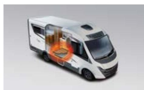
**Chauffage par le sol** grâce à des câbles de chauffage à réglage automatique (K-Yacht Teknoline) ou pellicule de chauffage (K-Yacht Tekno Design), selon le modèle, dans des parties spécifiques du camping-car.
