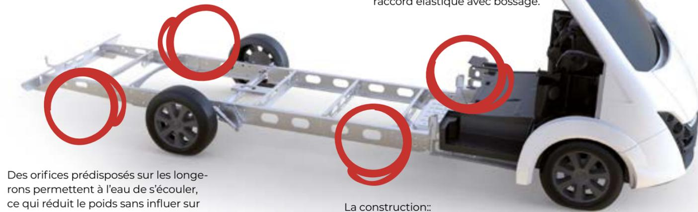
Des orifices prédisposés sur les longerons permettent à l'eau de s'écouler, ce qui réduit le poids sans influencer sur la solidité. L'utilisation d'acier haute résistance garantit une stabilité remarquable.
