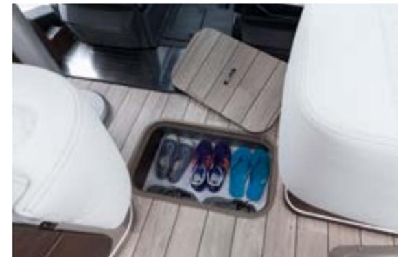
**POSSIBILITE DE PLUS DE RANGEMENTS** Grâce au double plancher technique, nous avons des trappes de rangement fonctionnelles pour différentes sortes d'objets et bouteilles aussi bien à l'avant qu'à l'arrière du véhicule. Des rangements dans le bas de caisse avec portillons sont accessibles de l'extérieur.
